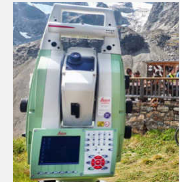
Hochmoderne Präzisionsmessgeräte sichern Positionierung auf wenige Millimeter.
